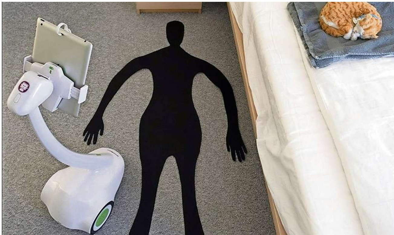
Der Roboter löst den Alarm aus. Falls Frau Brönnimann (im Bild eingezeichnet ist ihr Schatten) stürzt und nicht wieder aufstehen kann, verbindet sich der Tablet-Roboter (links im Bild) automatisch mit ihrem Notfallkontakt.
